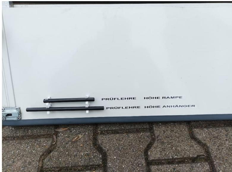
Die beiden Prüflehren sind an der Heckklappe des Anhängers zu finden.
