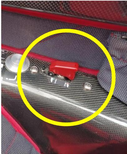
Bei Defekt in der Steuerungselektronik oder leerer Motorbatterie kann das Fahrwerk mit dem integrierten Notsystem ausgefahren werden.
