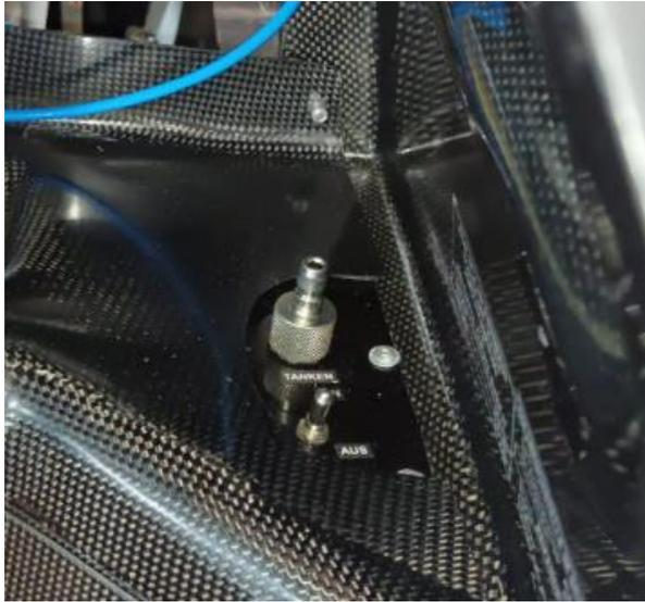
Der Betankungsstutzen befindet sich im Cockpit links hinter dem hinteren Sitz.
