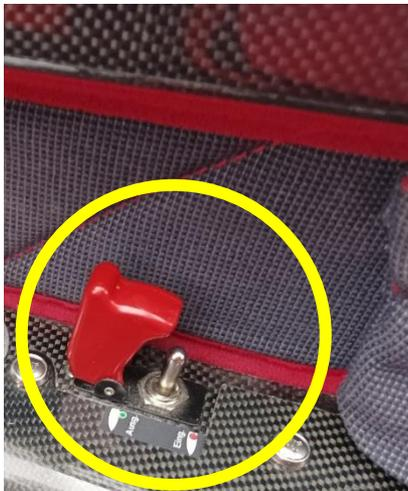
Rote Sicherungsklappe öffnen und Schalter nach vorne gedrückt halten zum ausfahren oder nach hinten gedrückt halten zum einfahren.
